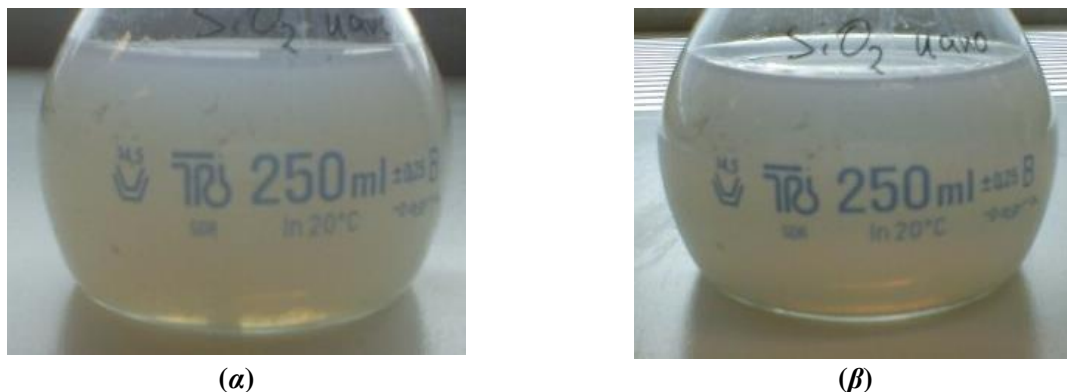
Σχήμα 2: Οπτική παρατήρηση για τον έλεγχο της σταθερότητας του αιωρήματος: α) 1 η μέρα και β) 25 η μέρα χωρίς μηχανική ανάδευση.
